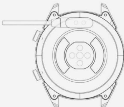
\* La montre se recharge par un système magnétique. Connectez les points aux tiges de chargement à l'arrière du boîtier selon le modèle ci-dessous. La recharge débutera automatiquement. Attention à ne pas court-circuiter les deux points de chargement.
